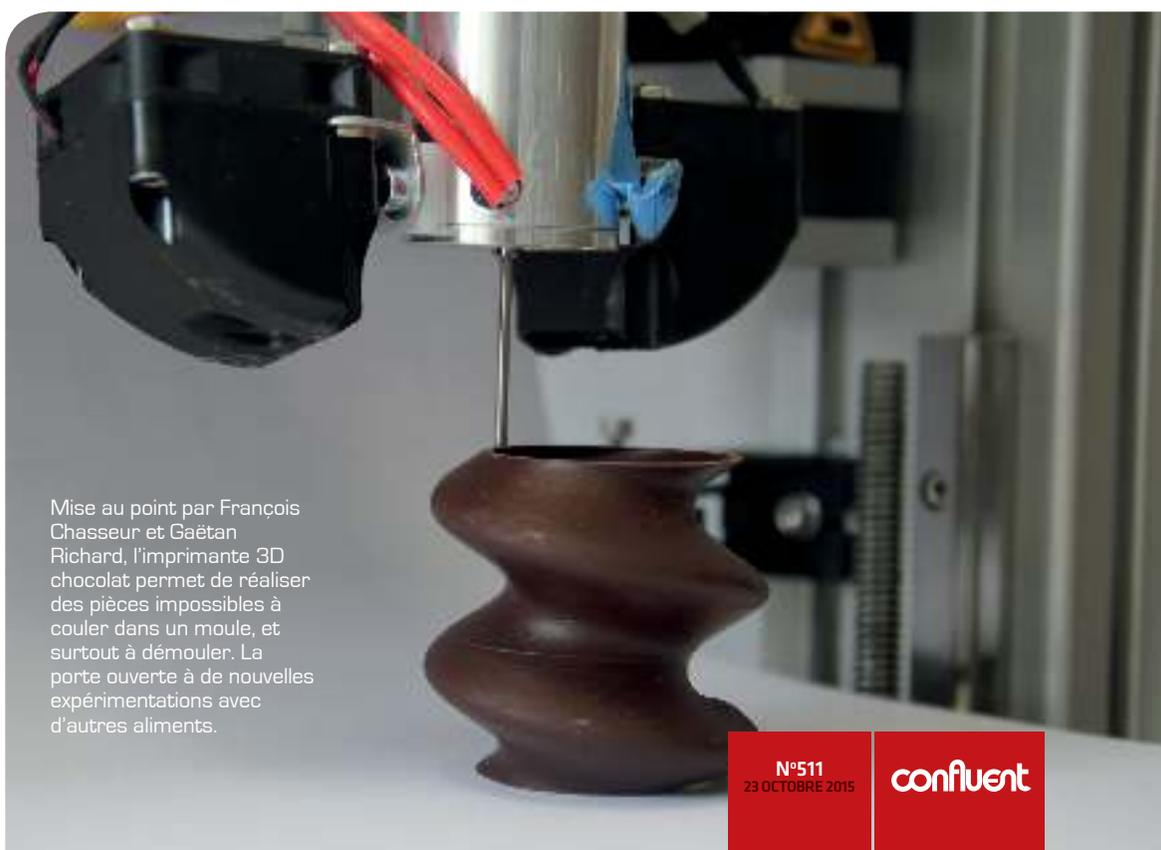
Mise au point par François Chasseur et Gaëtan Richard, l'imprimante 3D chocolat permet de réaliser des pièces impossibles à couler dans un moule, et surtout à démouler. La porte ouverte à de nouvelles expérimentations avec d'autres aliments.
